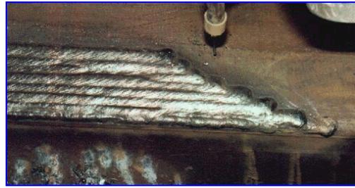
Spezialprogramm zum Hartbeschichten mit unterschiedlichen Bereichen und Beschichtung unterschiedlicher Formen an großen Platten.
